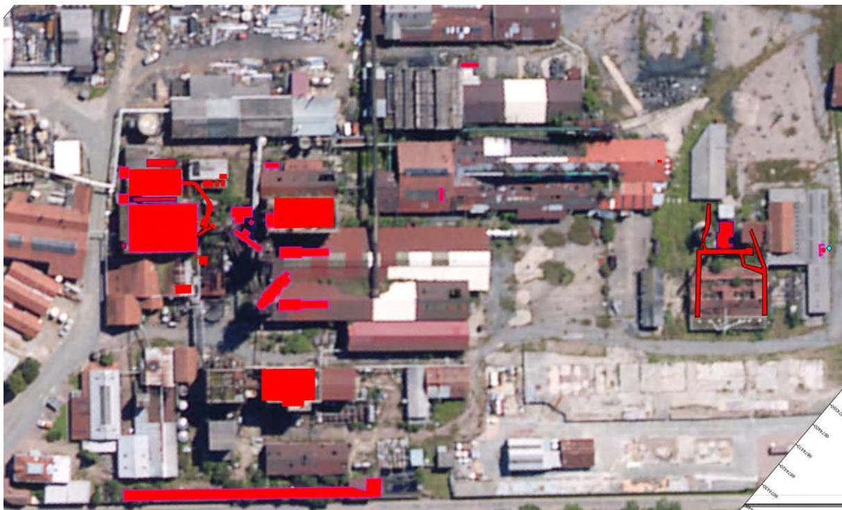
**Figure 32 Localisation des principaux vides (y compris sous sols suspectés)**
