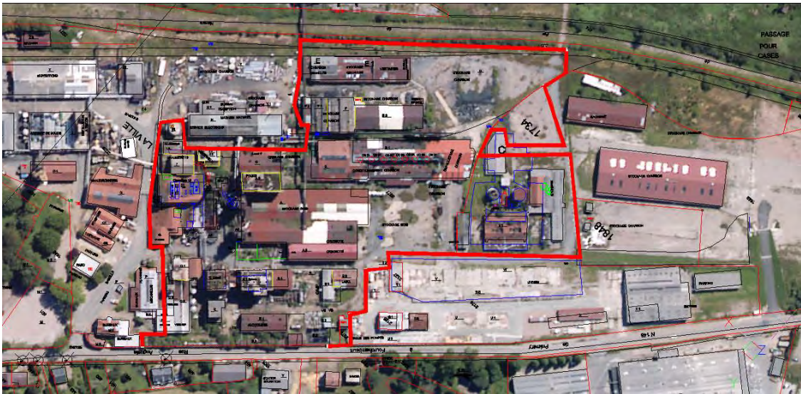
Figure 51 Emplacement de la clôture finale définitive (en grillage) selon limites cadastrales
