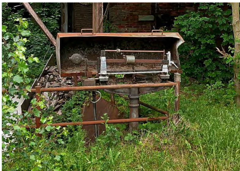
Figure 2 Bascule du skip des fours
