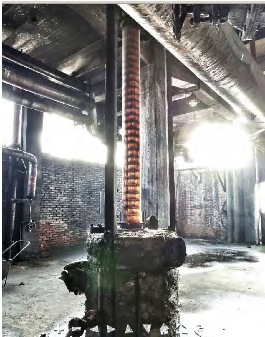
Figure 5 Colonne en verre des fours
